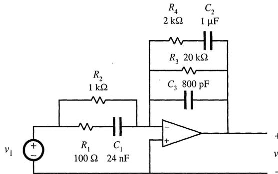
**Fig. 8.67** Op-amp PID controller circuit, Problem 8.10.
