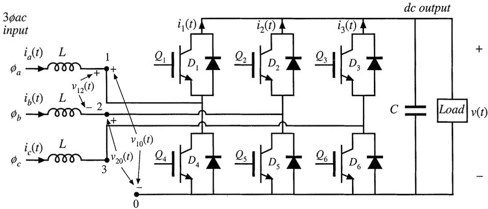
Fig. 18.39 Boost-type 3 $\phi$ ac–dc PWM rectifier.
