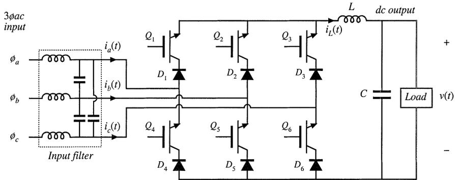
Fig. 18.44 Buck-type 3 $\phi$ ac–dc rectifier, Problem 18.8.
