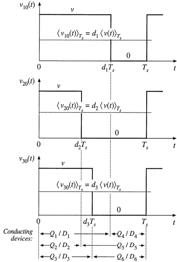
Fig. 18.40 Switch waveforms, 3 $\phi$ ac-dc boost rectifier.
