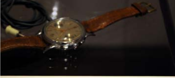
Kol Saati Görünümlü Kayıt Cihazı İçerisine yerleştirilen mikrofona sayesinde ortamdaki seslerin ses kayıt cihazı üzerine kaydedilmesini sağlayan kol saati.
